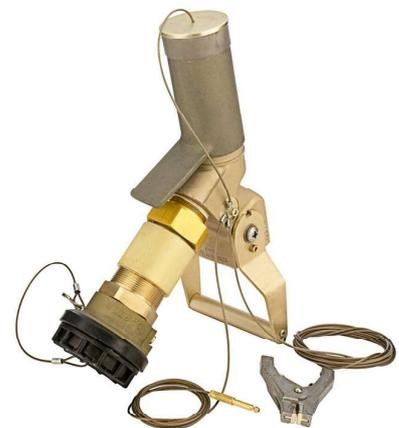
O CCR 64017 foi desenhado para ser conectado a veículos, helicópteros e unidades de terra. O bocal vai limitar a pressão no adaptador do veículo/helicóptero a 15 psi (1.03 Bar) independentemente da pressão de entrada e cumpre os últimos requerimentos *U.S. Army* MIL-PRF-52747F (suplanta MIL-N-53094). Versões árticas encontram-se também disponíveis.
